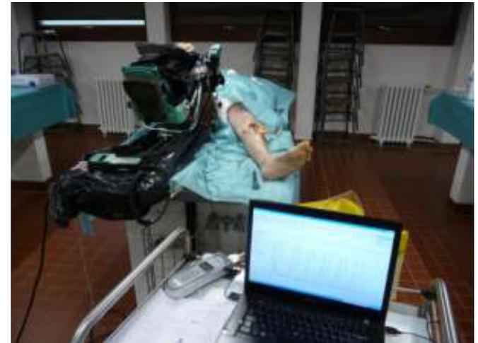
*Acquisition des données sur logiciel pendant plusieurs cycles de flexion extension*
